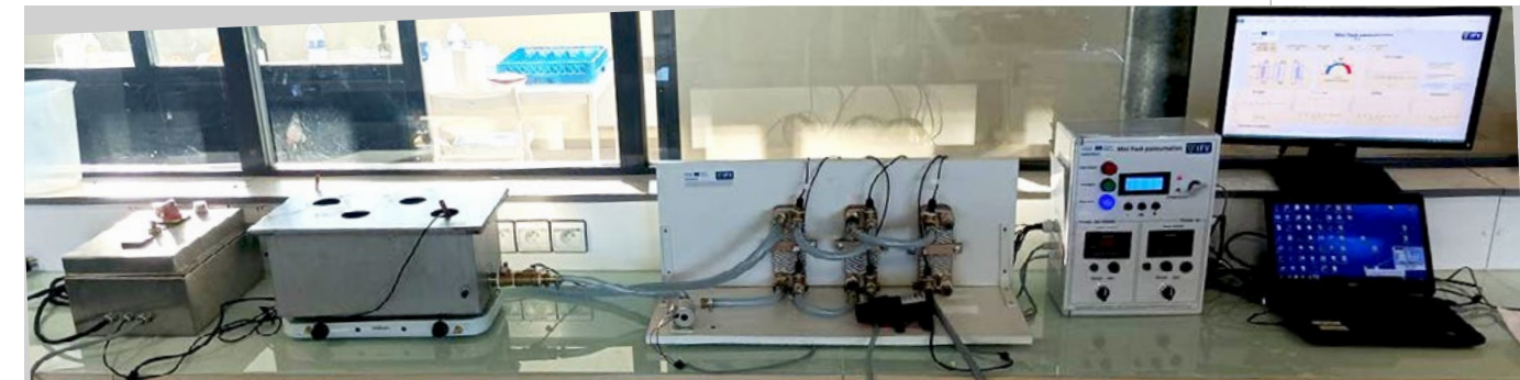
Système de flash pasteurisation pour tester des protéases
